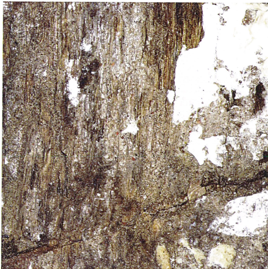
Slika 22: Površina vzorca izolirana iz nosilca 4. Na površini so vidni ostanki anorganskega premaza in/ali apnenega beleža. Analizirana površina je 56 mm 2 .
