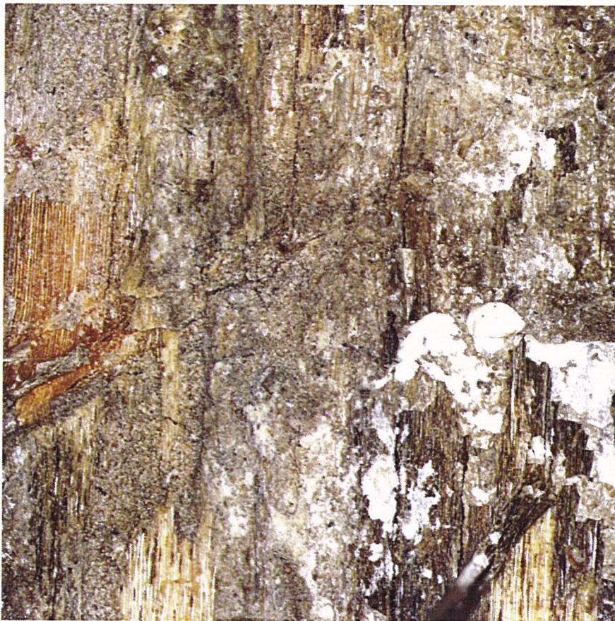
Slika 21: Površina vzorca izolirana iz nosilca 4. Na površini so vidni ostanki anorgankega premaza in/ali apnenega beleža. Analizirana površina je 56 mm 2 . Upoštevati je treba, da je del anorganskih depozitov odpadel zaradi grobega postopka izolacije vzorca.
