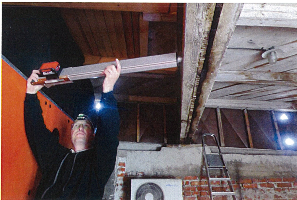
Slika 5: Analiza lesa z resistographom
