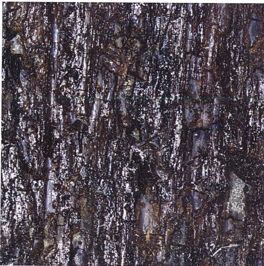
Slika 20: Površina vzorca izolirana iz nosilca 2. Površina je svetleča. Na površini so vidni depoziti, kar kaže na to, da je bila premazana z oljem. Analizirana površina je 56 mm 2 .
